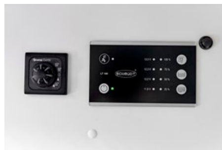
Bord-Control-Panel met weergave van alle vulniveaus en batterijcapaciteiten
